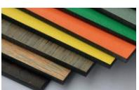
**Płyta HPL** – to materiał wykonany z kilku lub kilkunastu warstw papieru impregnowanego żywicą fenolową, sprasowanych przy użyciu wysokiego ciśnienia i temperatury oraz papieru impregnowanego żywicą melaminową. Płyty HPL cechują się wysoką wytrzymałością oraz odpornością na działania atmosferyczne, a także czynniki mechaniczne.
