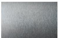
**Stal nierdzewna** – stal o właściwościach fizykochemicznych, odpornych na korozję. Nierdzewność otrzymuje się dzięki wprowadzeniu do stali odpowiednich dodatków stopowych.
