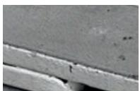
**Powłoka geomet** - polega na pomalowaniu metalowych elementów powłoką antykorozyjną geomet. Ochrona powierzchni na bazie wody zawierającej mikropłatki cynku. Powłoka ta stanowi bardzo dobrą alternatywę dla typowych powłok galwanicznych z racji znacznie wyższej odporności na korozję.
