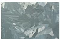
**Cynkowanie ogniste (zanurzeniowe)** – jest to globalnie stosowana metoda zabezpieczająca konstrukcje stalowe przed korozją, składająca się z kilku etapów. Celem cynkowania ognistego jest uzyskanie wielowarstwowej powłoki ochronnej. Prawidłowo wykonana powłoka cynkowa wg normy PN EN ISO 1461 wytrzymuje od 10 do 30 lat. Ponadto jest niedrogim oraz przyjaznym środowisku sposobem zabezpieczania stali przed korozją. Zaletami cynkowania są również wysokie walory techniczne oraz estetyczne.
