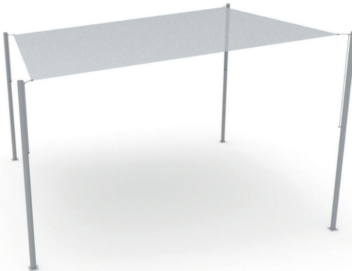
**Materiał:** słupy stalowe - 2szt. Ø 90mm o wysokości 2300 mm i słupy stalowe 2szt. Ø 90mm o wysokości 2800 mm - cynkowane ogniwo; materiał cieniujący PE o gramaturze 200 g/m<sup>2</sup> o przepuszczalności 50% i zacienieniu 50%. Tkanina odporna na warunki atmosferyczne.
