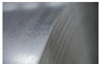
**Cynkowanie galwaniczne** – to czynność elektrochemiczna, której celem jest pokrycie powierzchni metalu powłoką cynku tak, aby ochronić produkt przed korozją. Efektem końcowym jest otrzymanie gładkiej powierzchni stali w kolorze złotym lub srebrnym. Prawidłowo wykonana powłoka cynkowa wytrzymuje od 2 do 10 lat.
